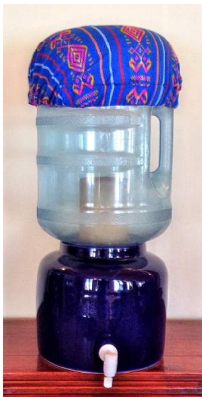
Figura 7.1. Filtro cerámico de agua de Caminos de Agua con base de cerámica para el almacenamiento seguro del agua.
